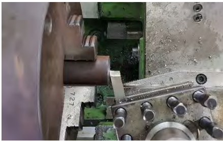
1. ปรับหน้ามีดกลึงทำมุมเอียงกับชิ้นงานประมาณ 10-15 องศา
