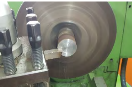
4. ทำการกลึงปาดหน้า โดยการเลื่อนชุดป้อมมีดจากศูนย์กลางของชิ้นงานออกมา
