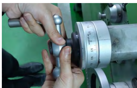
5. ในการกลึงปาดหน้าชิ้นงานให้หมุนที่ชุดแทนเลื่อนขวางจะต้องหมุนสม่ำเสมอและต่อเนื่องๆ
