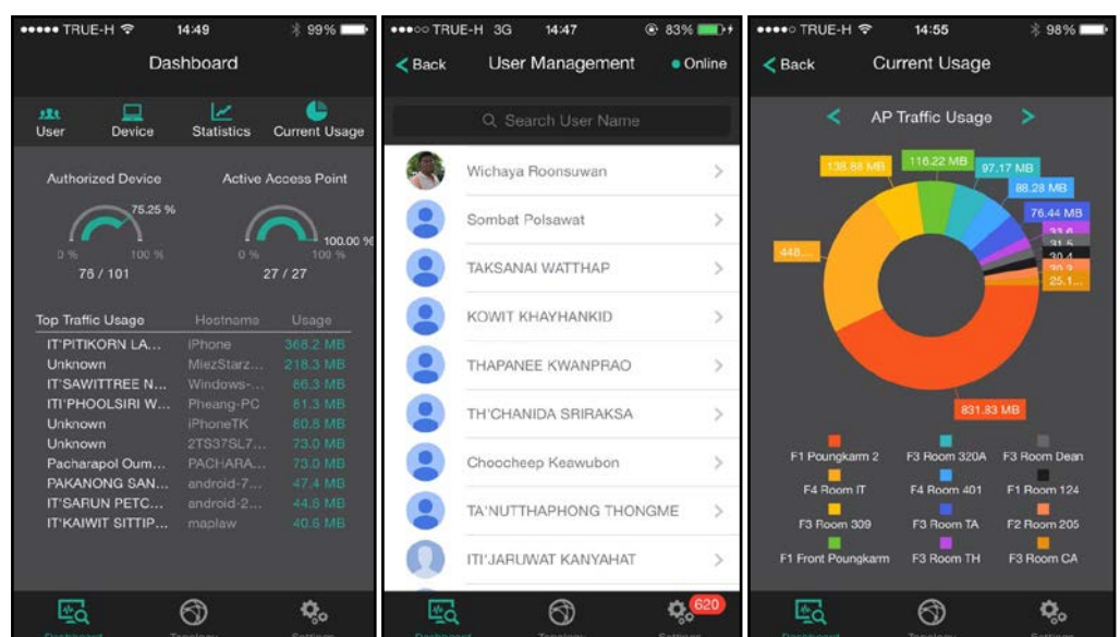
ภาพที่ 3 ด้านซ้ายแสดงลำดับของผู้ใช้งานเครือข่ายไร้สายสูงสุด กึ่งกลางแสดงข้อมูลผู้ที่กำลังใช้งานเครือข่ายไร้สายอยู่ ด้านขวาแสดงข้อมูลของอุปกรณ์เครือข่ายไร้สายที่มีผู้ใช้งานมากที่สุด
